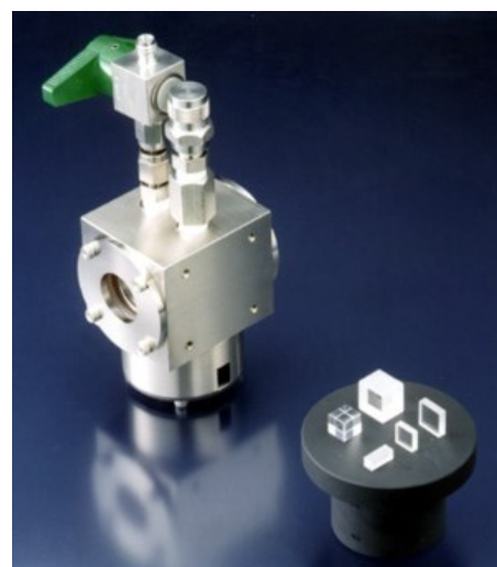
CLBO( \text{CsLiB}_6\text{O}_{10} )結晶と加熱セル
