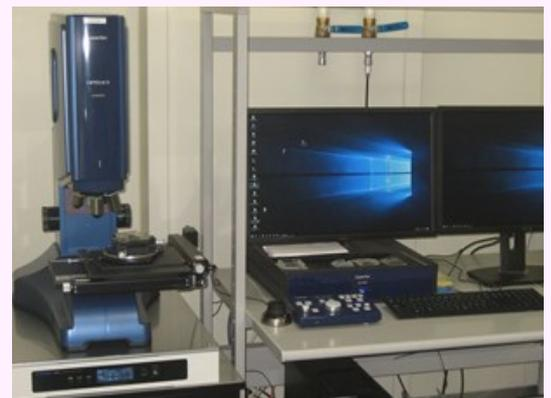
新規導入したレーザー顕微鏡
