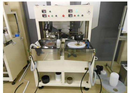
新規導入した高剛性タイプのオスカー型研磨機
